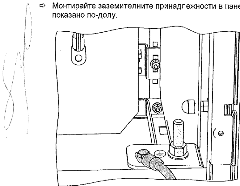
Фиг. 143: Заземителни принадлежности в панела мерене - изглед в кабелното отделение
